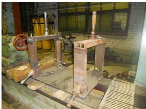
Рис. 1. Приспособление для установки втулки
