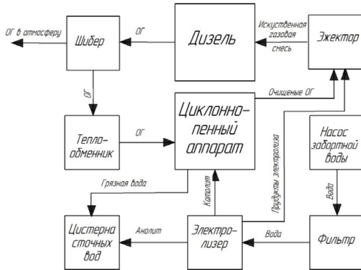
Рис. 1. Схема рециркуляции ОГ с очисткой в циклонно-пенном аппарате
