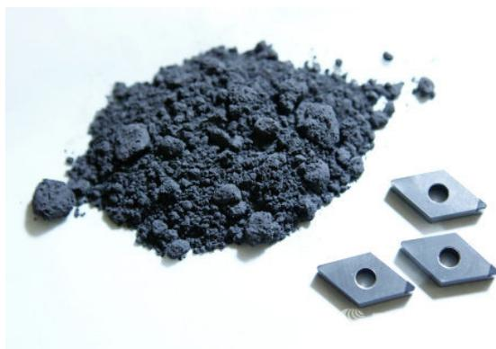
Рис. 1. Нанопорошок кубического нитрида бора и токарные пластины на его основе
