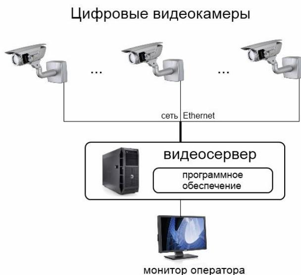
Рис. 1. Обобщенная структурная схема судовой системы видеонаблюдения
