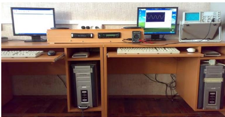
Рис. 1. Лабораторная установка по испытаниям автомагнитол
