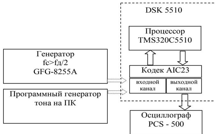
Рис. 2. Схема лабораторной установки
