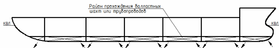
Рис. 1. Концептуальная схема безбалластного судна
