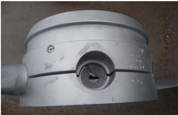
Рис. 2. Отделенная в результате разрушения часть комля в ступице винта
