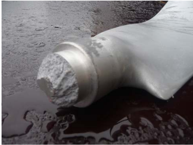
Рис. 1. Разрушенный комель и погнутая вследствие касания внутренней обшивки направляющей насадки лопасть
