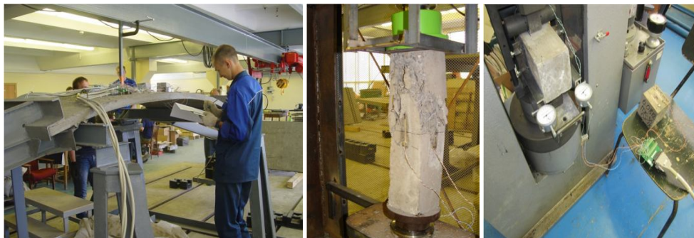
Рис. 1. Проведение статических испытаний образцов из фибробетона
