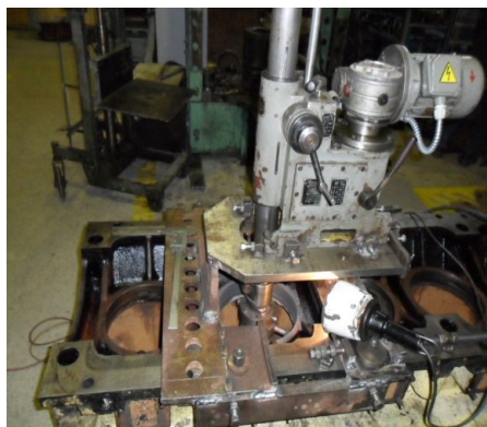
Рис. 3. Приспособление для расточки блока
