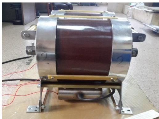
Рис. 2. Внешний вид трансформаторного датчика (ТД) плотности тока
