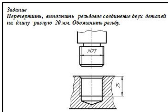
Рис. 2. Пример задания по инженерной графике по теме «Резьбовое соединение»
