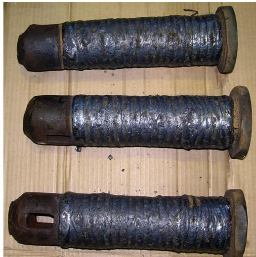
Рис. 2. Пальцы черпаковой цепи после наплавки
