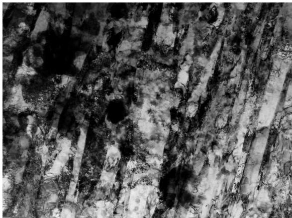
Рис. 5. Структура двухфазной стали с чередованием пластинчатых кристаллов аустенита с рейками мартенсита, термообработка 1.4,  $\times 20000$
