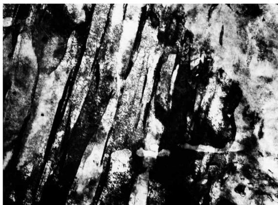
Рис. 3. Рейки  $\alpha$ -мартенсита и тонкие межреечные прослойки остаточного  $\gamma$ -аустенита, термообработка 1.1
