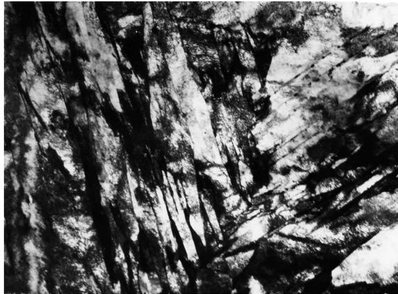
Рис. 1. Пакеты речного мартенсита в стали с термообработкой 1.2,  $\times 20000$
