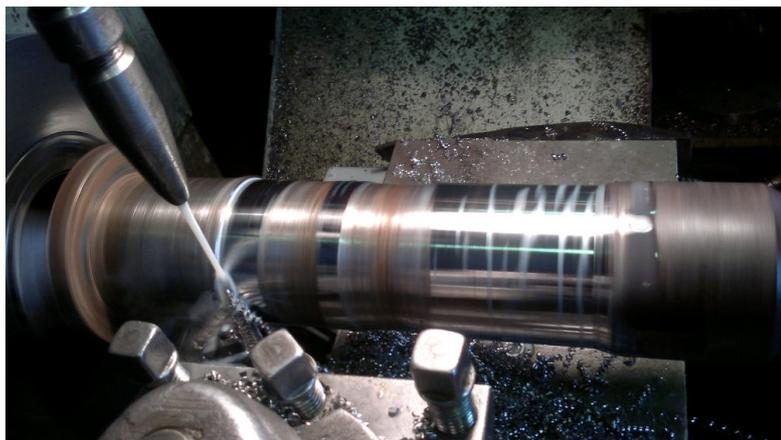
Рис. 3. Механическая обработка пальцев
