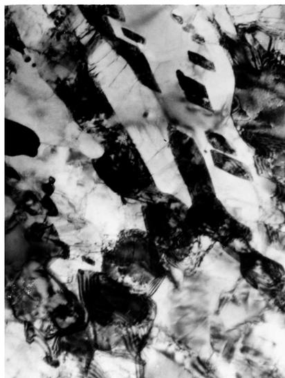
Рис. 9. Формирование полигональной структуры в мартенсите и аустените, термообработка 1.8,  $\times 40000$
