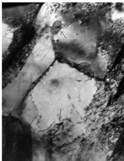
Рис. 6. Структура двухфазной стали, в которой наблюдаются полигональные стенки дислокаций в аустените, термообработка 1.5,  $\times 40000$
