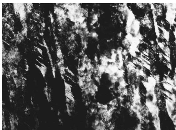
Рис.2. Двойники превращения в кристаллах реечного  $\alpha$ -мартенсита, термообработка 1.1,  $\times 20000$
