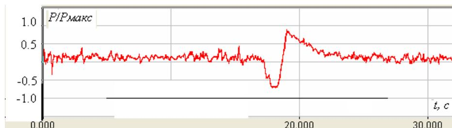
Рис. 3. Нормированная осциллограмма статического давления взлетающего самолета.
