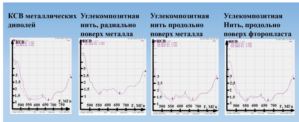
Рис. 4. Коэффициент стоячей волны диполей диапазона 600 МГц
