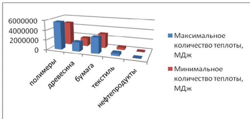
Рис. 3. Количество теплоты от сгорания компонентов отходов.
