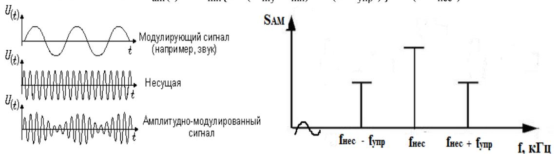
Рис. 8. Теоретическое представление амплитудно-модулированного сигнала (осциллограмма и спектр) при  $U_{му}=U_{мн}$ .
