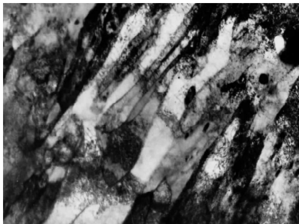
Рис.3. Структура стали 07X16H4Б, гомогенизированной при 1050°C, 25 часов и состаренной при 650°C, 3 часа,увелич. x10000.
