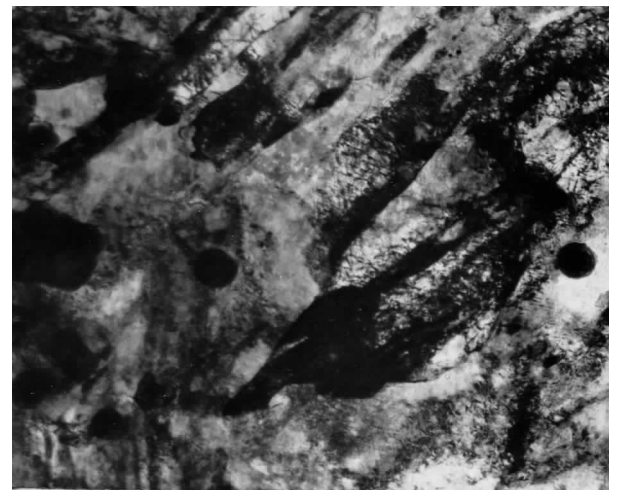
Рис.6. Структура стали 07X16H4Б после гомогенизации при 1150°С, 25 часов и термоциклированной обработки ( 3 цикла) при 1000°С, 2 часа с последующей закалкой от 1000°С, 2 часа, в масло и старением при 650°С, 3 часа, x20000
