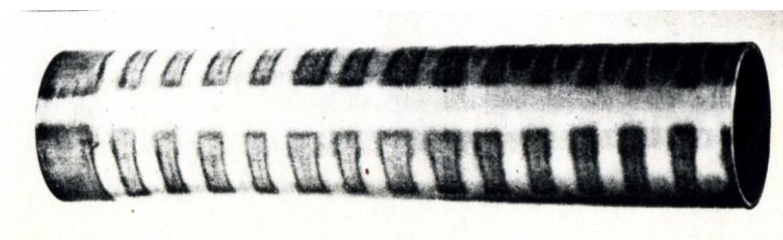
Рис.1. Макет якоря системы управления защиты АЭС - (темные участки - магнитная фаза - мартенсит; светлые участки - немагнитная фаза - аустенит).
