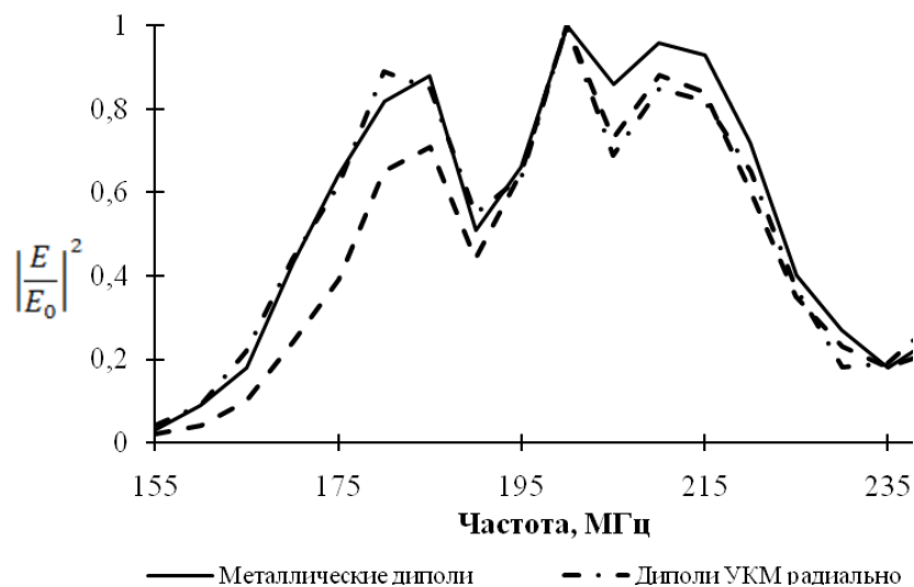
Рис. 7 Амплитудно-частотная характеристика дипольных антенн диапазона 200 МГц
