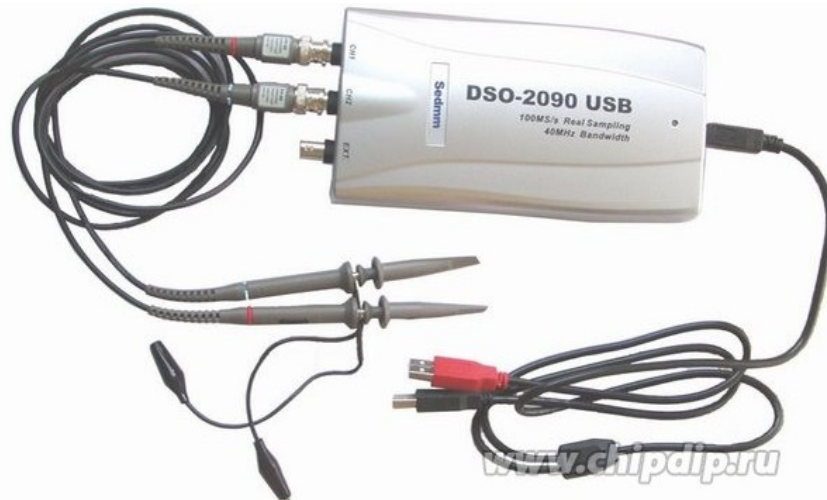
Рис. 1. Внешний вид цифрового осциллографа DSO-2090
