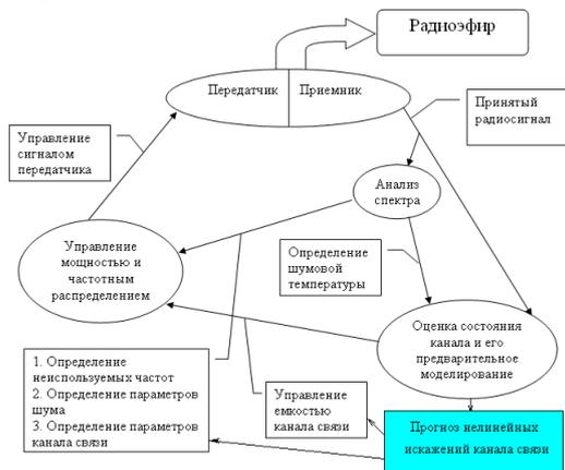
Рис. 3 Схема взаимодействия при когнитивном управлении каналом связи
