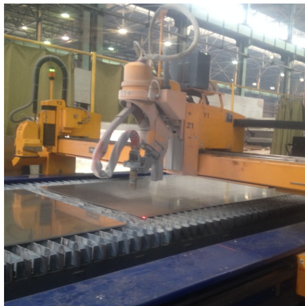
Рис. 2. Подготовка к плазменной резке на судостроительных верфях.
