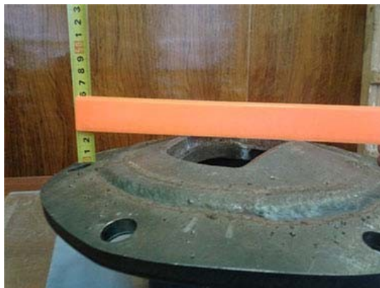
Рис. 3 Вид экспериментального образца после приложения предельной нагрузки
