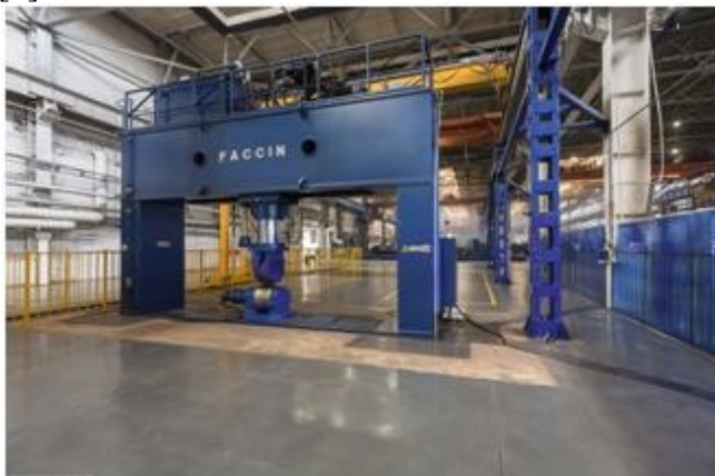
Рис. 4. Пресс «Faccin» PPM-500/6 (Италия) для трёхмерной гибки деталей двойкой кривизны
