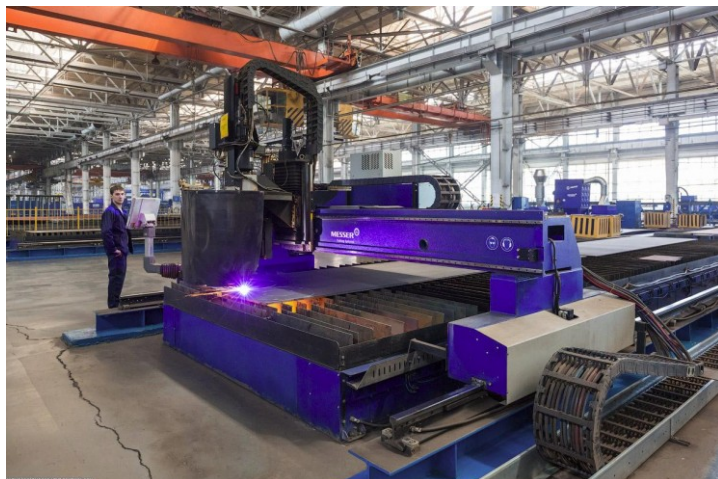
Рис. 2. Автоматическая машина плазменной резки Messer(Германия)
