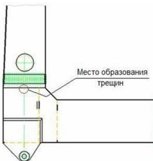
Рис. 11 Место образования трещин в жёсткой опоре
