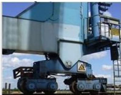
Рис. 21 - Соединение опоры с балансиrom
