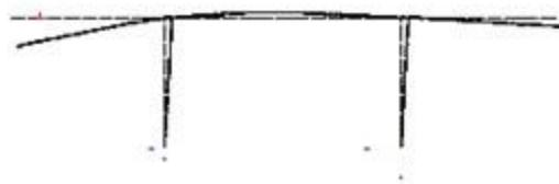
Рис. 4. Деформации крана (случай 1).
