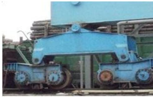
Рис. 22 - Соединение опоры с балансиrom
