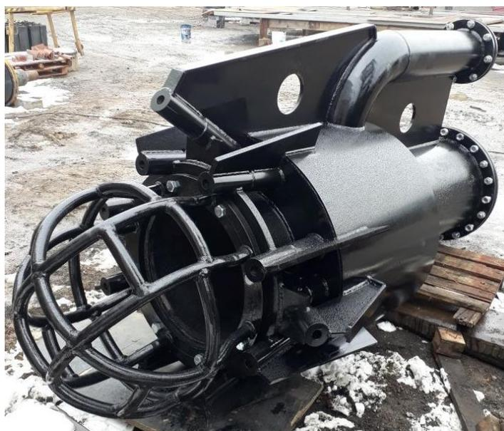
Рис. 2. Общий вид грунтоприемника
