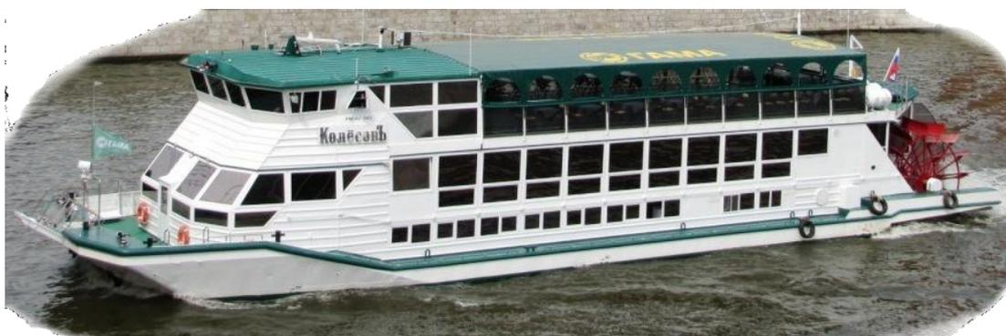
Рис. 1. Судно с колесным двигательно-рулевым комплексом
