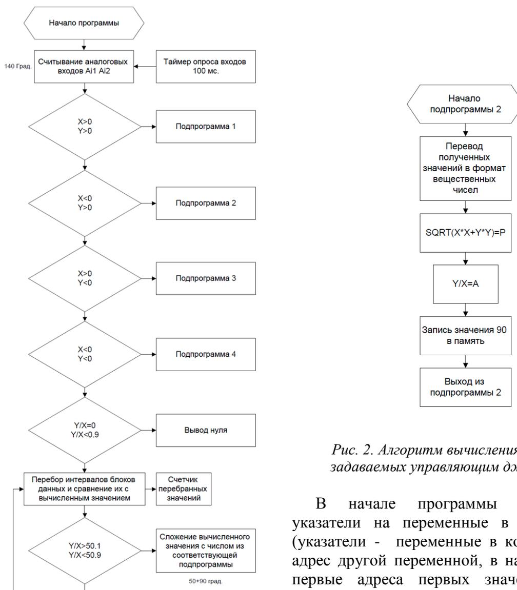
Рис. 2. Алгоритм вычисления параметров, задаваемых управляющим джойстиком
