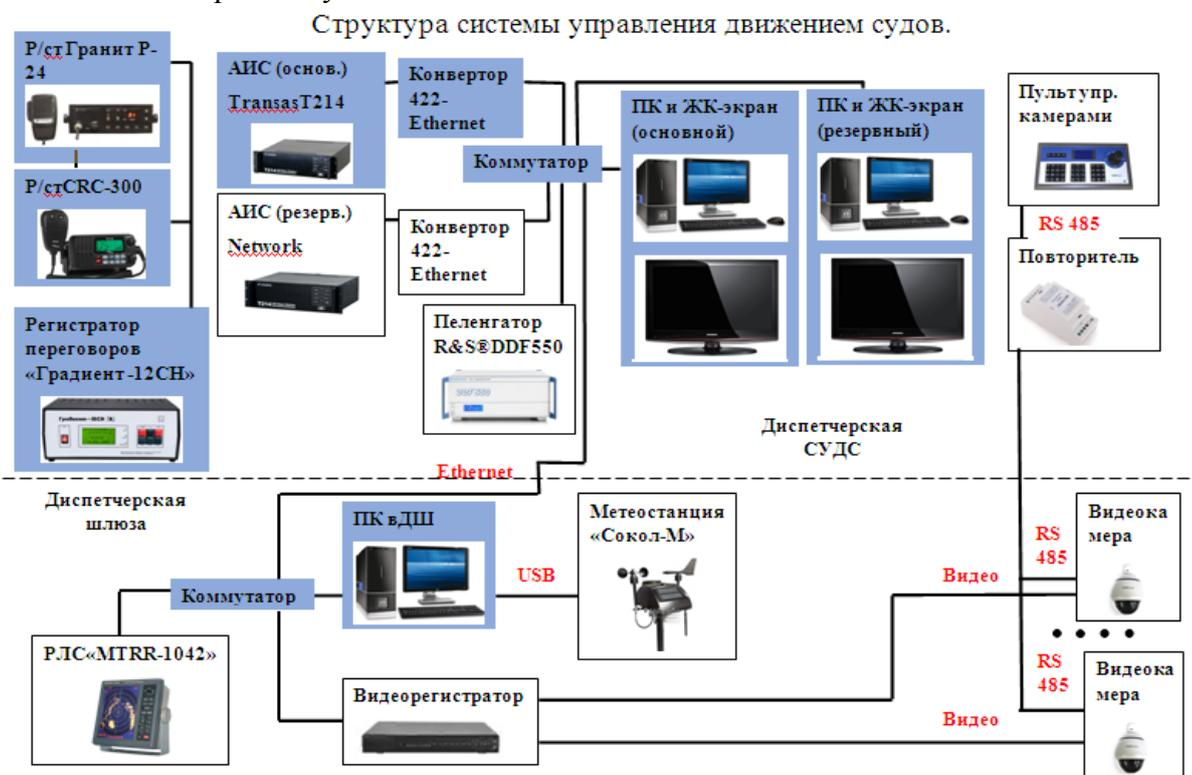
Рис.1. Структура системы управления движением судов в районе Нижегородского гидроузла.
