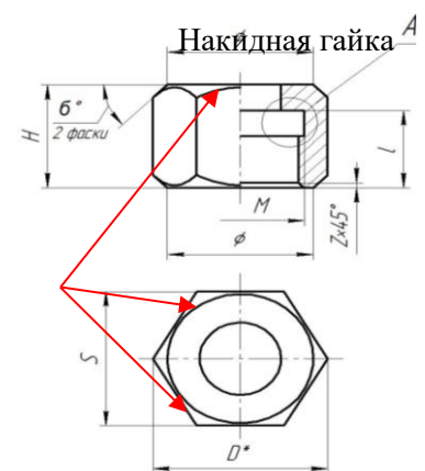
Рис. 12 Линии пересечения поверхностей
