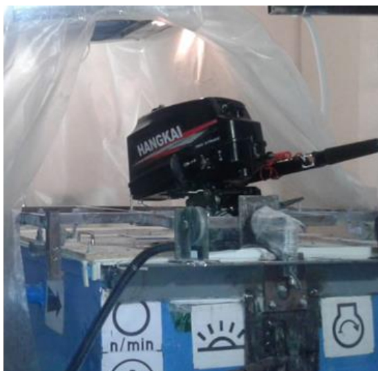
Рис. 1. Обкатка ПЛМ «Hangkai 4.0» для проведения испытаний
