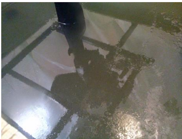
Рис. 2. Загрязнения воды ПЛМ «Hangkai 4.0» после 10-ти минут работы
