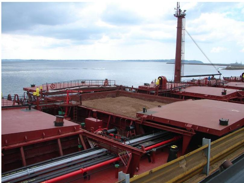
Рис.3. Нефтенавалочники-рудовозы типа OBO (Oil/Bulk/Ore carrier)
