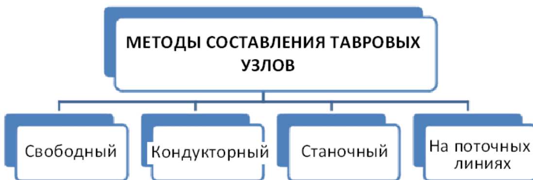
Рис. 2. Классификация методов изготовления тавровых узлов.
