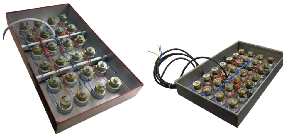
Рис. 5. Пример исполнения ультразвукового генератора
