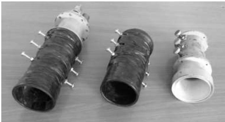
Рис.1 Внешний вид углекомпонитных рупорных антенн
