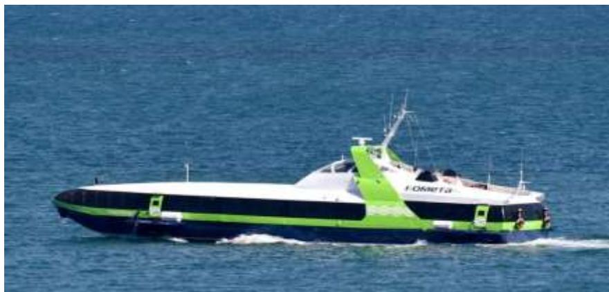
Рис. 1. Морское пассажирское судно на подводных крыльях типа «Комета-120М»
