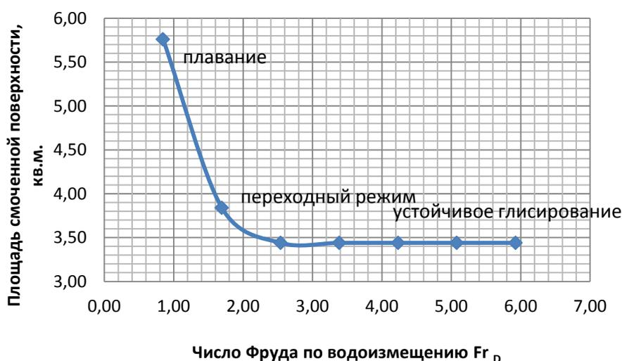
Рис.2. Изменение площади смоченной поверхности лодки при различных режимах движения
