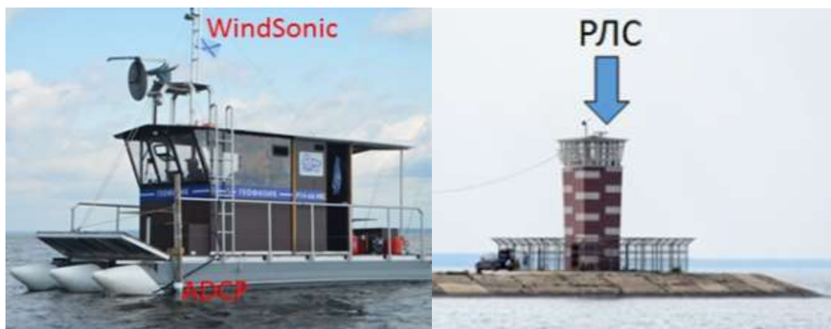
а) б) Рисунок 1. Натурный эксперимент по формированию пленочного слика от пузырькового потока: а) плавучая лаборатория «Геофизик», оснащенная оборудованием для подачи воздуха, акустическим доплеровским измерителем течений (ADCP) и ультразвуковым датчиком скорости и направления ветра WindSonic; б) маяк аванпорта, на котором располагался локатор кругового обзора сантиметрового диапазона Микран MRS-1000.
