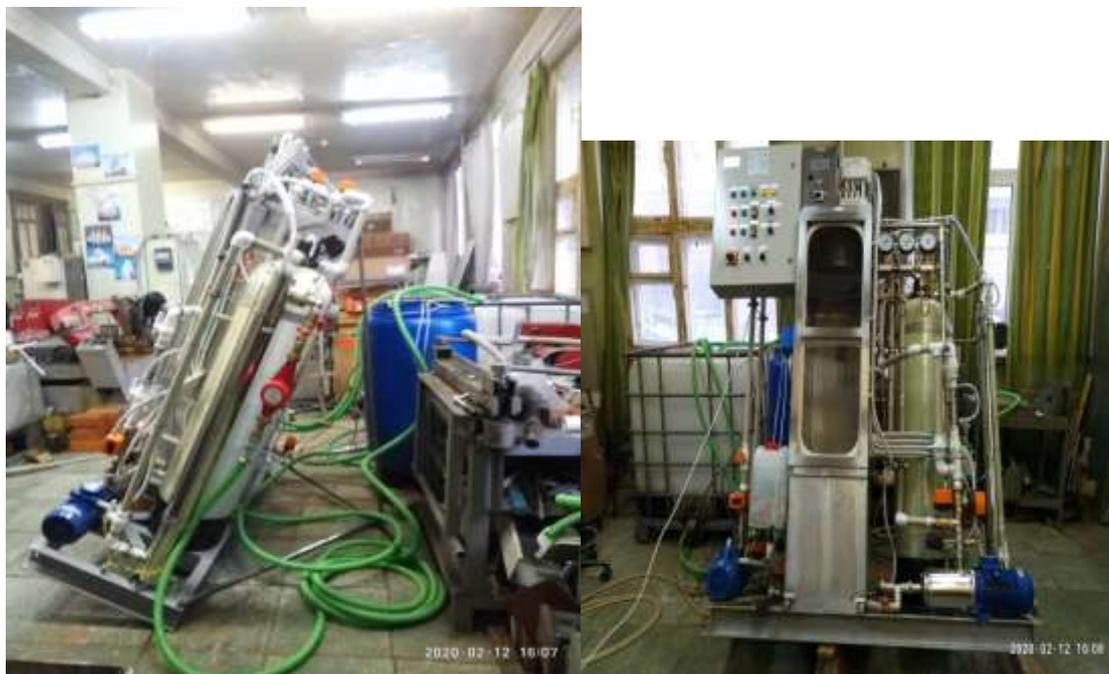
Рис.2. Новая станция очистки сточных вод СОСВ-2М. Стендовые испытания.
