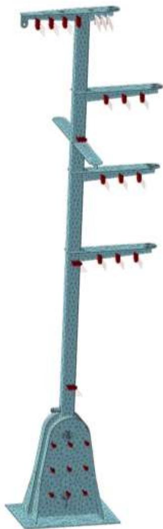
Рис. 2. – Внешний вид КЭ сетки и распределение нагрузки 480 Па на боковую поверхность элементов
