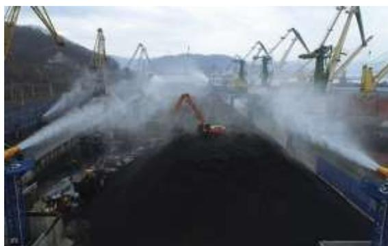
Рис. 2. Система пылеподавления
