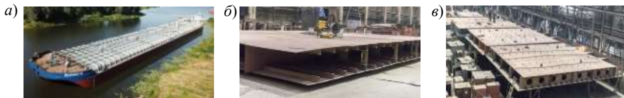
Рис.14. Нефтеналивная баржа типа «Белмакс» (пр. ROB20): а - на плаву, б и в – в постройке конструкция ДД
