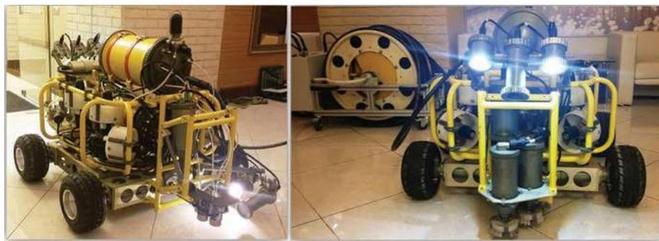
Рис.1. ТНПА для оценки технического состояния корпуса судна [1].
