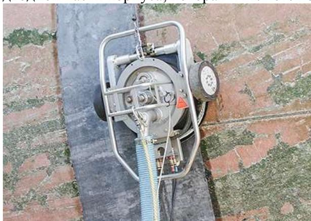
Рис.3. Вакуумная установка для очистки металлических поверхностей [2].
