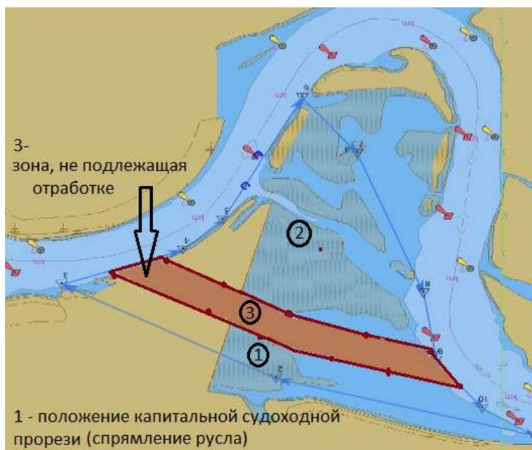
Рис.2. Очередность разработки карьера ПГП.
