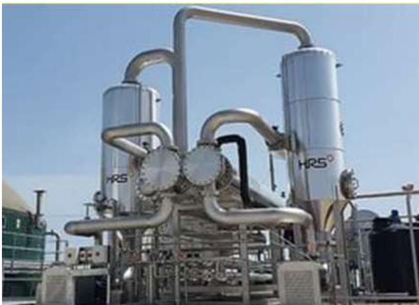
Рис.3 Промышленное устройство для обезвоживания мазута
