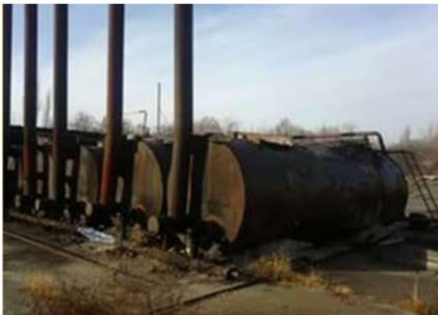
Рис.2 Простейшее устройство для обезвоживания мазута.
