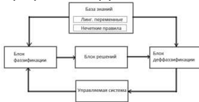
Рис.1. Структура микроконтроллера, работающего на нечеткой логике
