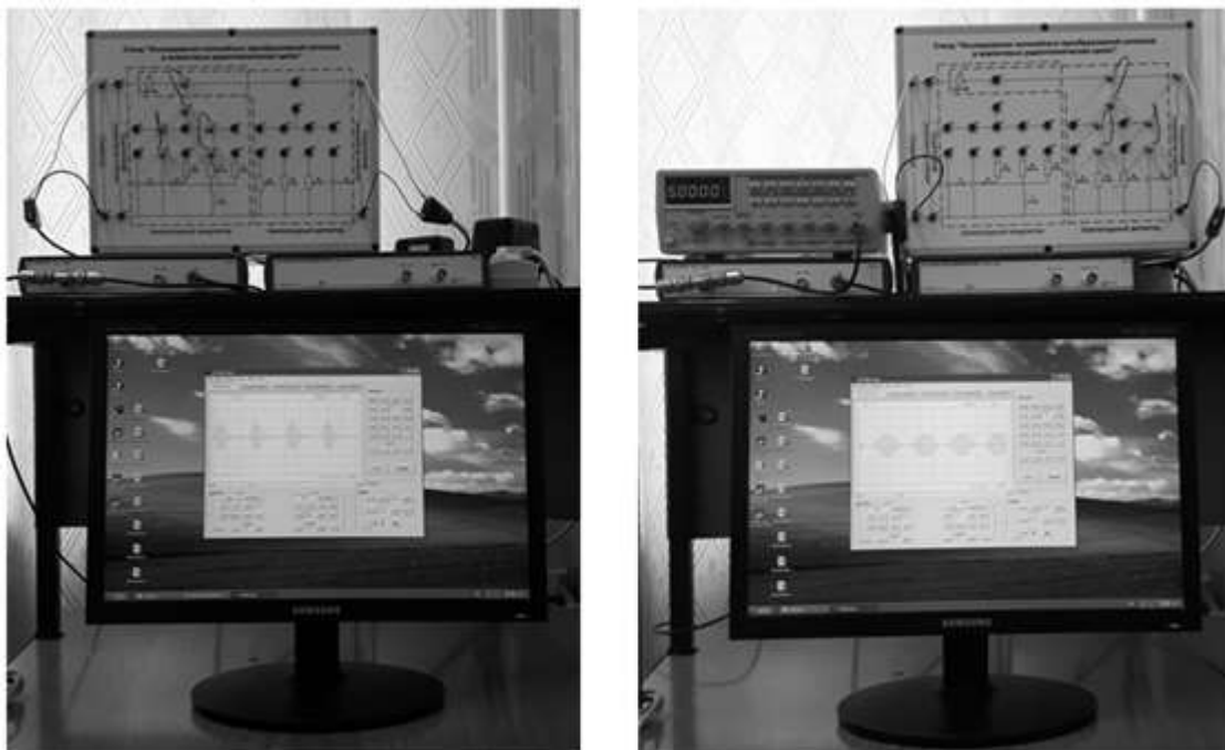
Рис. 6. Фото лабораторной установки для исследования амплитудного модулятора (слева) и амплитудного детектора (справа).
