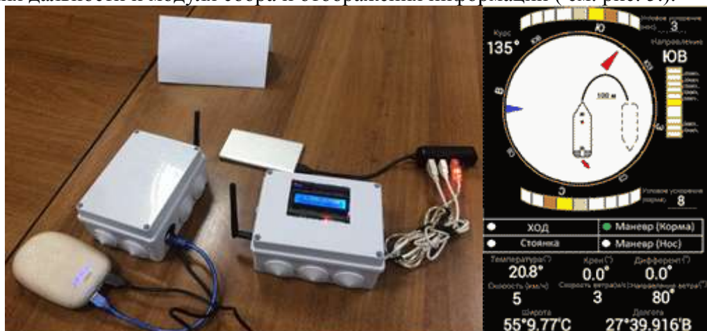
Рис. 5. Макетная реализация системы датчиков и примерный интерфейс программного обеспечения.
