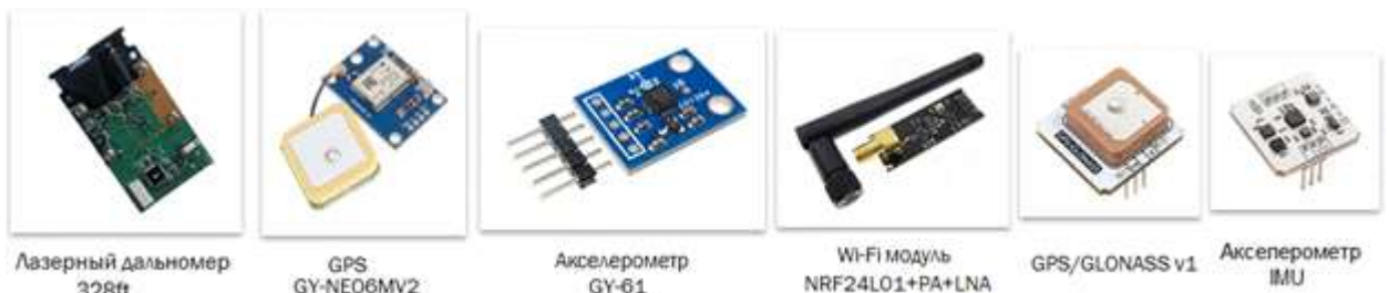
Рис. 3. Выбранное оборудование для реализации системы помощи судоводителю при швартовных операциях.
